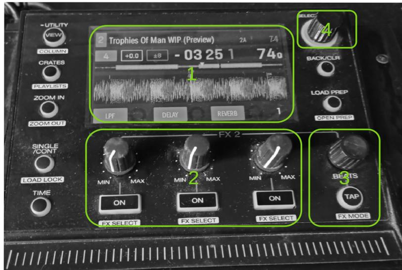
Figure 5: Vue de la partie haute du deck du contrôleur Denon DJ - MCX800 ;
