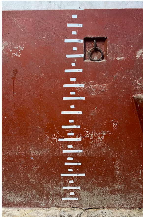
Figure 11 : Échelle graduée (5 cm) pour mesurer le port de tête, à côté de l’anneau d’attache
