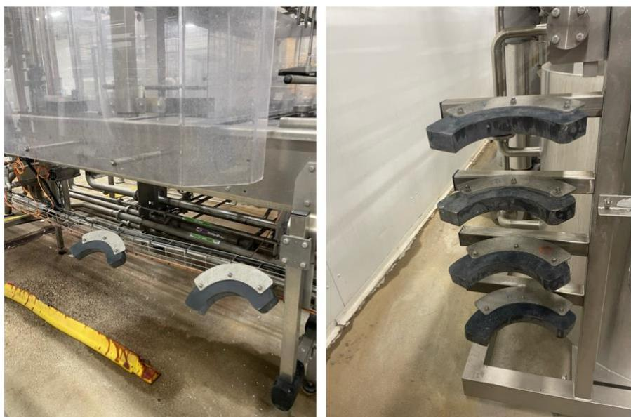
Figure 7 : Création d'un support pour les modules de changement de format
