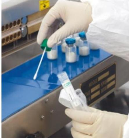
*Figure 24 : Technique swab avec un écouvillon (29)*
