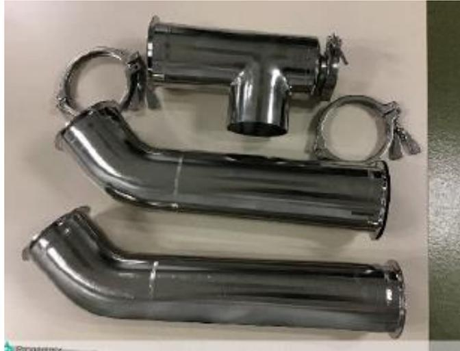
*Figure 22: Système d'aspiration des poudres démonté pour nettoyage*
