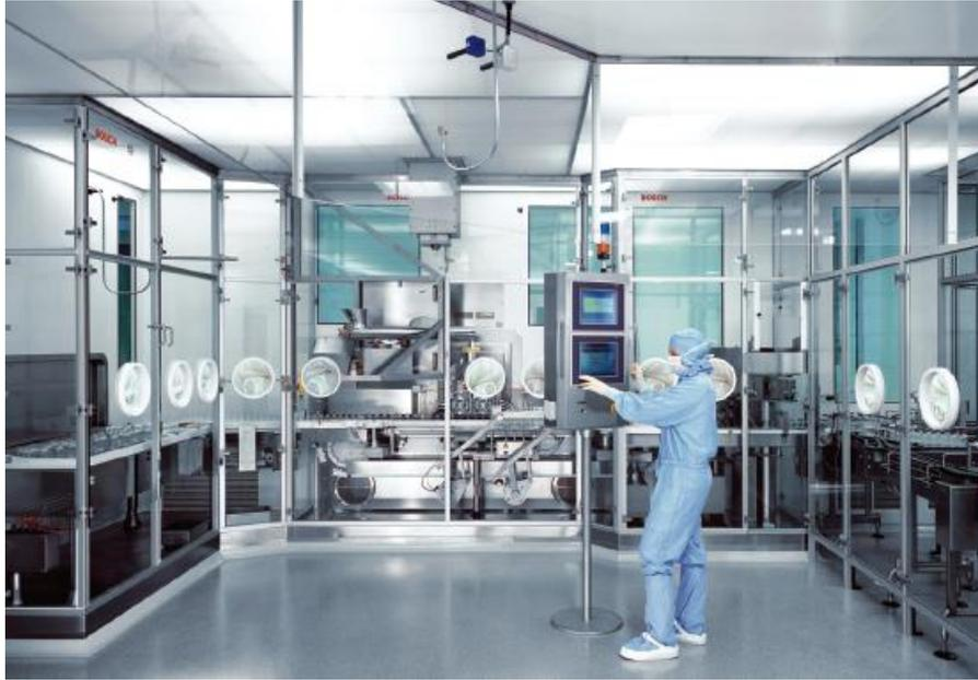
*Figure 7 : Exemple d'une ligne de remplissage aseptique avec RABS fermé passif (24)*
