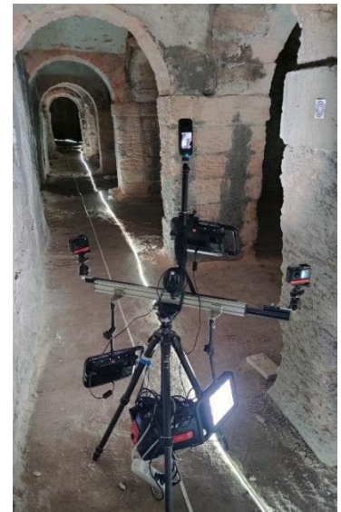
Figure 25 : Illustration de l'acquisition du souterrain par photogrammétrie.
