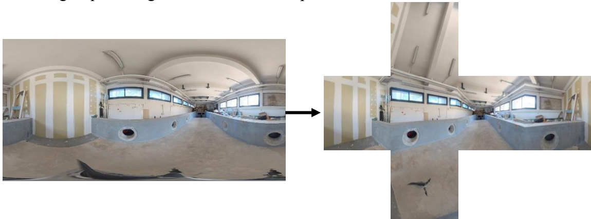
Figure 16 : Transformation d'une image équirectangulaire en 6 images cubiques.
