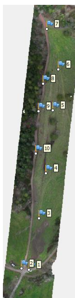
Figure 19 : Placement des points de contrôle au sol
