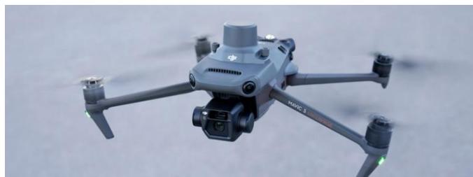
Figure 6 : DJi Mavic 3 Enterprise équipé d'un module RTK (Source : studioSPORT.fr )
