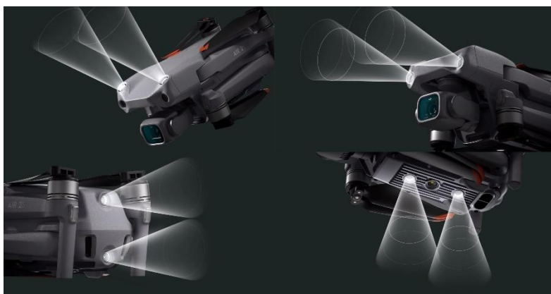
Figure 7 : Système de détection d'obstacles DJI (Source : https://www.helicomicro.com/ )
