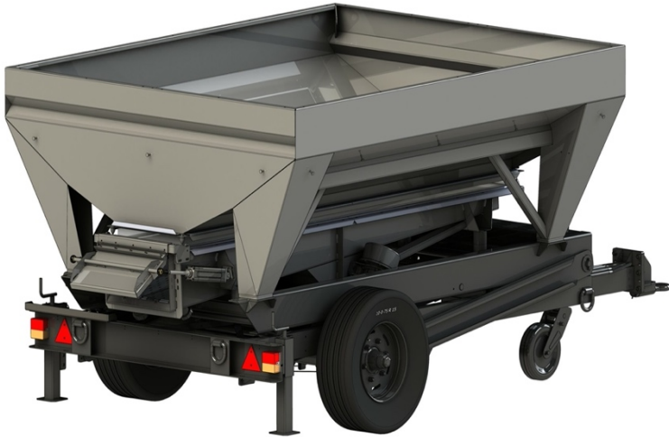
Figure 17 : Photographie de la remorque élévatrice vibrante Amos utilisée au Château Yvonne (Amos, 2023)
