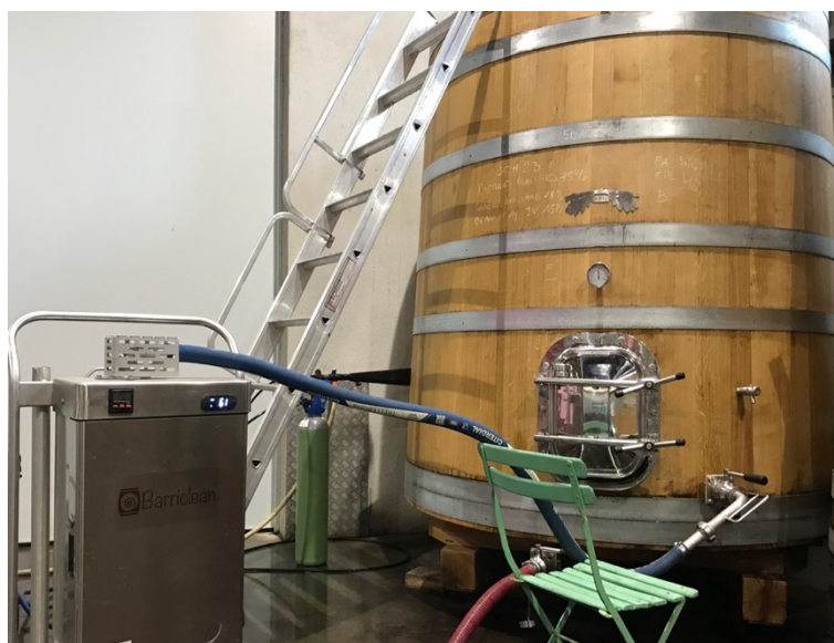
Figure 40 : Photographie du nettoyage d'une cuve bois à l'aide du Barriclean
