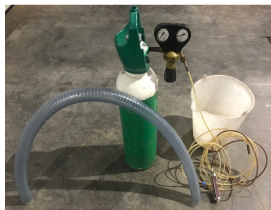
Figure 32 : Dispositif d'injection d'oxygène au moût en fin de fermentation alcoolique
