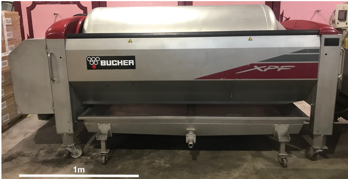
Figure 19 : Photographie du presseur XPF 22 du Château Yvonne
