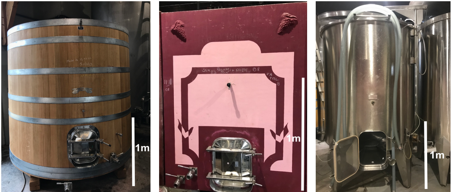
Figure 10 : Photographies des cuves de vinification du Château Yvonne. De gauche à droite : cuve tronconique bois (65hL), cuve parallélépipédique béton (50hL), et garde-vin cylindrique inox (50hL)
