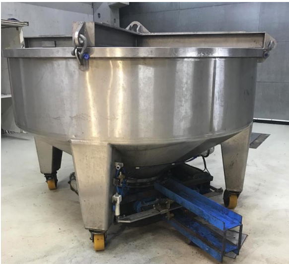
Figure 11. Images de l'OVI de transports de vendange ou de marc (à gauche) et le rail permettant de transporter cet OVI (à droite).
