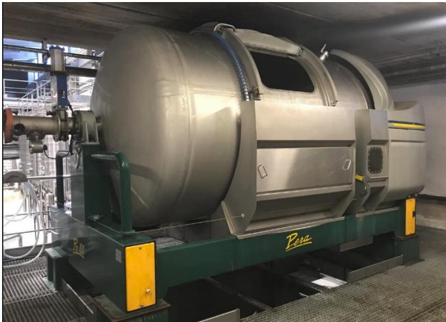
Figure 10. Images des deux pressoirs (pressoir 1 à gauche et pressoir 2 à droite) situé dans la zone 4. Ces deux pressoirs sont côte-à-côte. La partie en dessous de ces pressoirs appartient toujours à la zone 4 et correspond à la zone où l'on récupère le marc sec après un pressurage.
