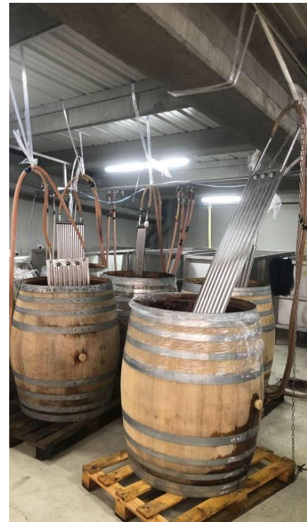
Figure 24. Demi-muids de FA pour les modalités expérimentales avec les drapeaux inox pour la gestion du froid.
