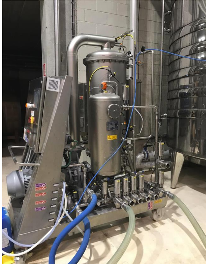
Figure 34. Appareil de micro filtration tangentielle du Mas Miraflor (modèle CFK-N à membrane céramique de la marque Della Toffola).
