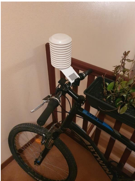
Figure 70: Photo d'une station météo montée sur un vélo pour les campagnes de mesures itinérantes - Source : L. Perier
