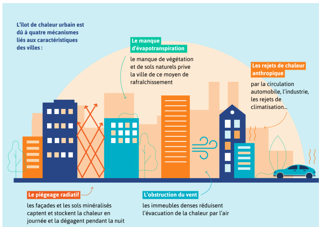
Figure 10: Schéma synthétisant les principaux mécanismes à l'origine de la modification du bilan énergétique en ville - (Agence Parisienne du Climat, 2024)
