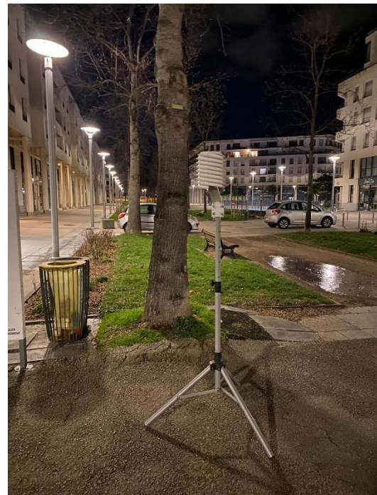
Figure 71: Station météo montée sur un trépied utilisé pour les campagnes de mesures temporaires itinérantes ou fixes – Source : C. Zangerl
