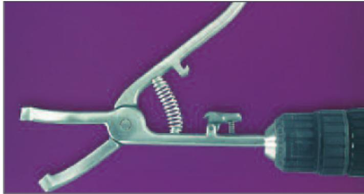
**Figure 10** : Photographie d'une pince de Henderson montée sur une perceuse-visseuse (D'après Capucille, Poore and Rogers, 2002)
