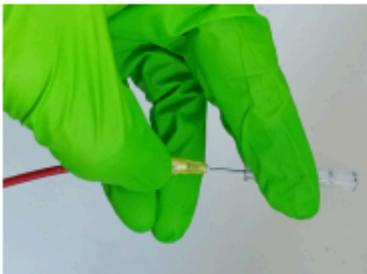
7. Placer le capuchon préalablement coupé sur l'aiguille connectée au circuit, **en faisant attention de ne pas se piquer.**
