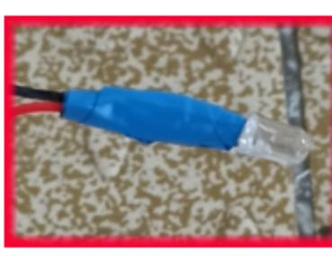
8. Si l'aiguille n'est pas enfoncée au bon endroit, la LED rouge ne s'allume pas. Dans ce cas, repositionner l'aiguille.
