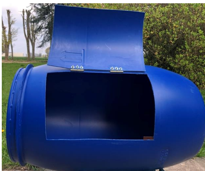
Figure 37 : Évolution de la construction du corps après création de la trappe (cliché M. NOGUES)
