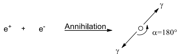
Schéma 44 : Désintégration d'un noyau émetteur \beta^+ et annihilation d'un positon.
