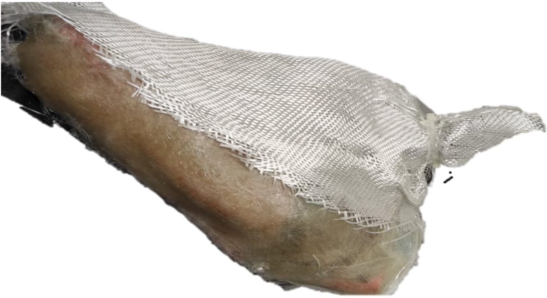
Figure 28 : Dépôt de couche de résine et fibre de verre sur la tête (Naeye, 2021)
