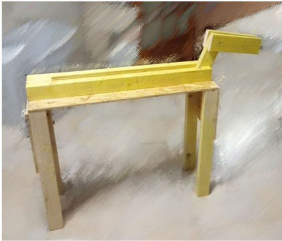
Figure 49 : Deux tasseaux vissés à un panneau de contreplaqué forment la colonne
