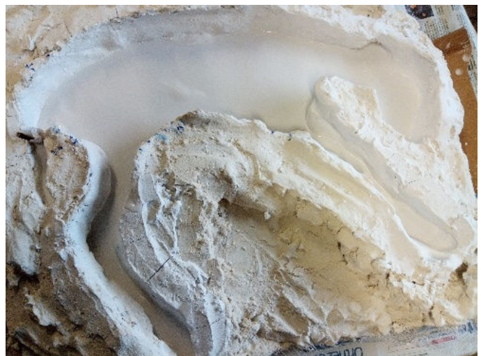
Figure 25 : Une première couche de silicone est déposée au fond du moule en plâtre servant à fabriquer le fœtus
