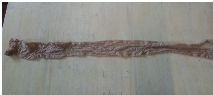
Figure 33 : L'intestin grêle a été modélisé à l'aide de bas en jersey
