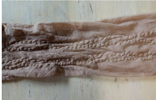
Figure 34 : Les bas en jersey ont été cousus dans leur longueur puis découpés pour obtenir des tuyaux flexibles
