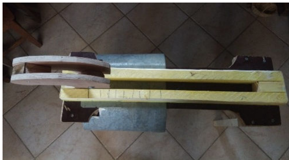
Figure 51 : Une plaque en acier inoxydable cintrée forme le thorax
