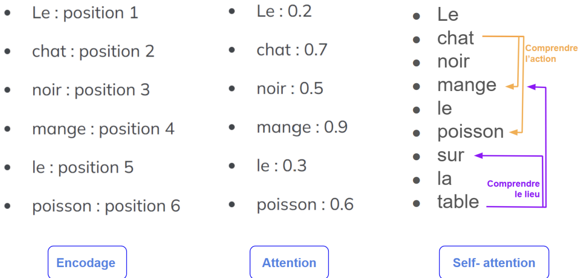
Figure 13 : Principe de fonctionnement des “transformers”.
