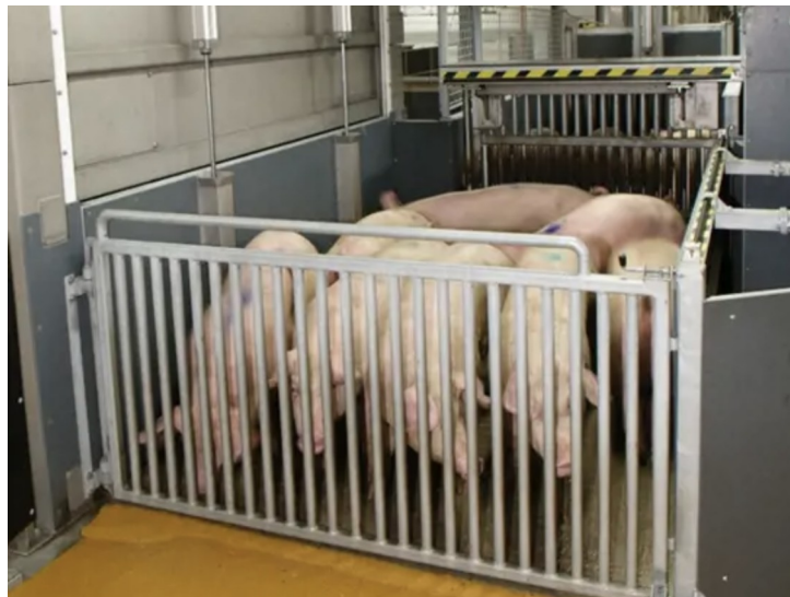
Figure 18 : Dispositif d'étourdissement au CO 2
