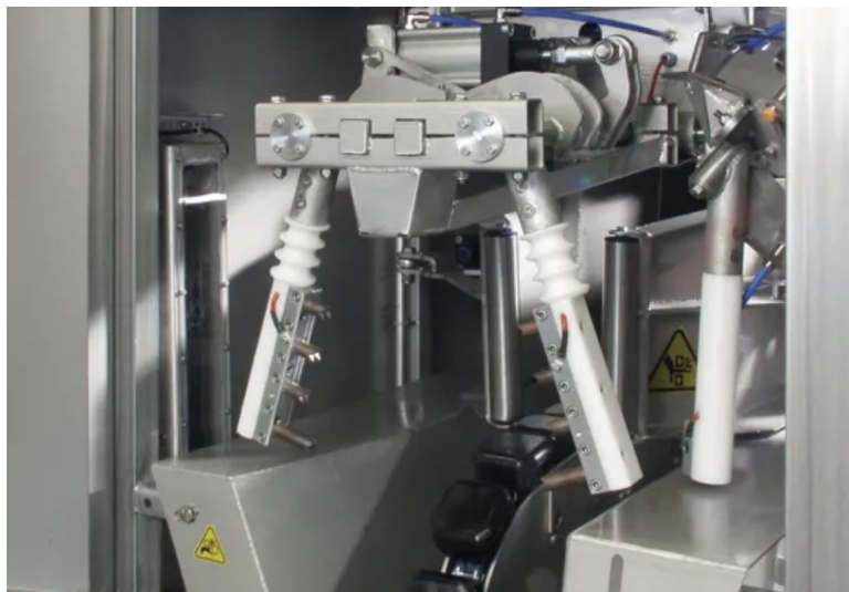
Figure 17 : Machine d'étourdissement par électro-narcose à 3 points ( www.marel.com )
