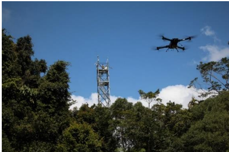
Figure 5 : Exemple de méthode d'acquisition dynamique à l'aide d'un scanner laser posé sur un drone Source : eo.belspo.be
