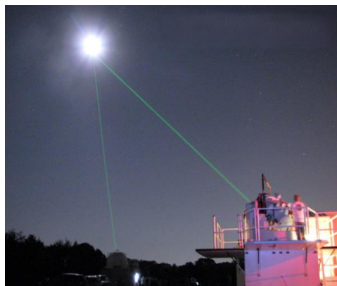
Figure 1 : Faisceaux lidars montés sur des télescopes afin de mesurer la distance Terre-Lune Source : Revue NASA
