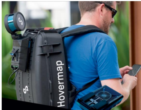
Figure 11 : Scanner HoverMap ST-X de Emesent porté sur le dos de l'opérateur, Source : emesent.com
