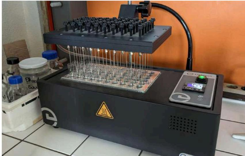
**Figure 30 : évaporation du surnageant à 40°C sous un flux d'air (photographie personnelle)**
