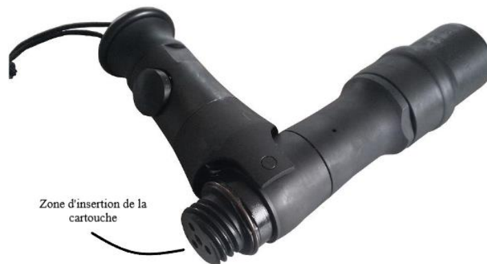
Figure 5: Pistolet à tige perforante en position ouverte exemple du type Super Sécurité 3000 de Termet.
