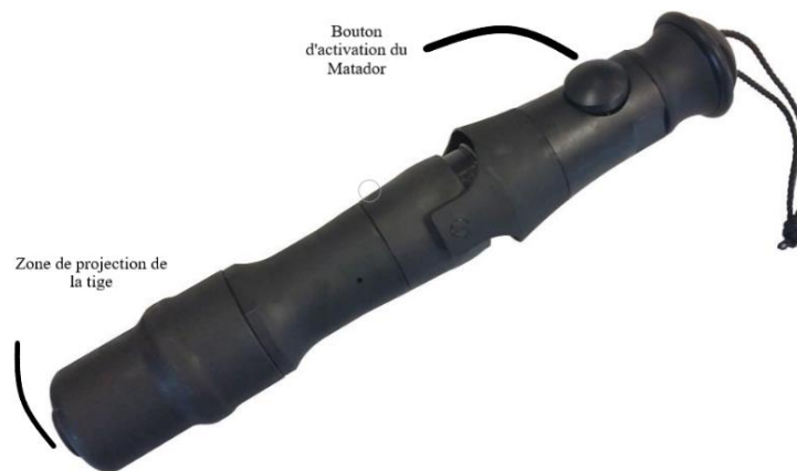
Figure 6 : Pistolet à tige perforante en position fermée exemple du type Super Sécurité 3000 de Termet.
