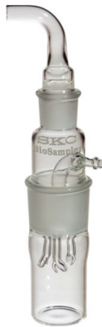
Figure 5 : Impacteurs sur milieu liquide. (A) Modèle BioSampler (SKC Ltd). (B) Modèle Coriolis® (Bertin Technologies).
