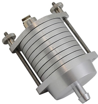
Figure 4 : (A) Impacteur à fente à 5 étages Sioutas (SKC Ltd). (B) Impacteur à 2 étages cycloniques BC251 (NIOSH).
