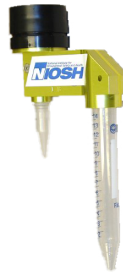
Figure 4 : (A) Impacteur à fente à 5 étages Sioutas (SKC Ltd). (B) Impacteur à 2 étages cycloniques BC251 (NIOSH).
