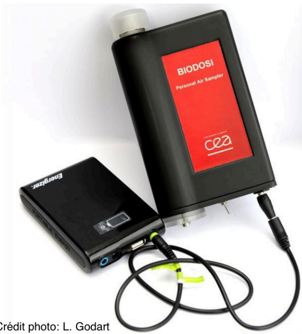
Figure 7 : Collecteur Biodosi (Roux et al. 2014).
