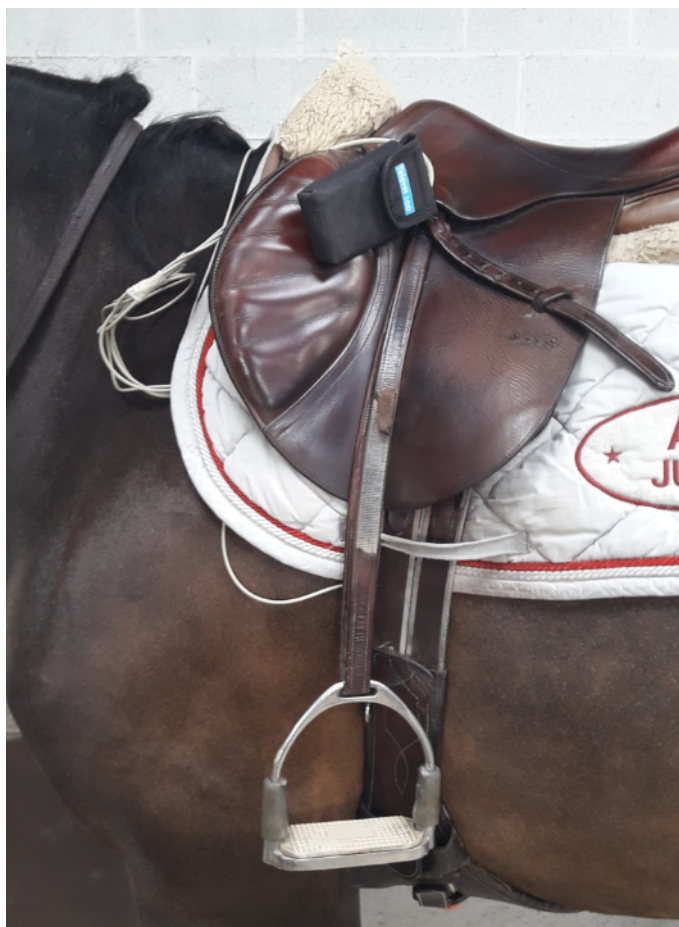
FIGURE 38 – Le Télévet 100 (KRUUSE) mis en place sur cheval sellé (source : Victoire Moucheboeuf).
