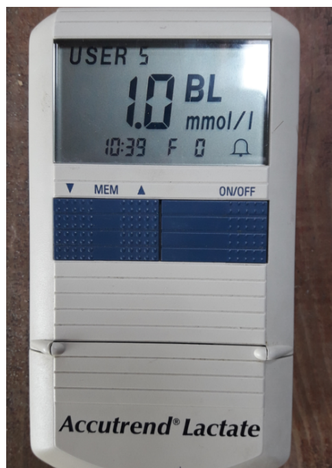
FIGURE 40 – Lactatomètre affichant la valeur la lactatémie après 60 secondes de lecture (source : Victoire Moucheboeuf).
