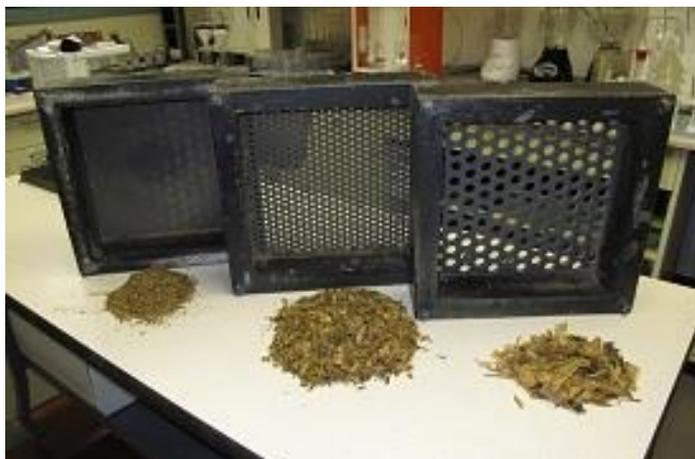
*Figure 14 : Illustration des trois tamis constitutifs du Penn State Separator (CVAS) Les mailles de 19mm, 8mm et 1,18 mm permettent de séparer la ration analysée en quatre fractions : grandes particules/ particules moyennes/ particules fines/ particules très fines. Les particules très fines ne sont pas présentes sur l'illustration.*
