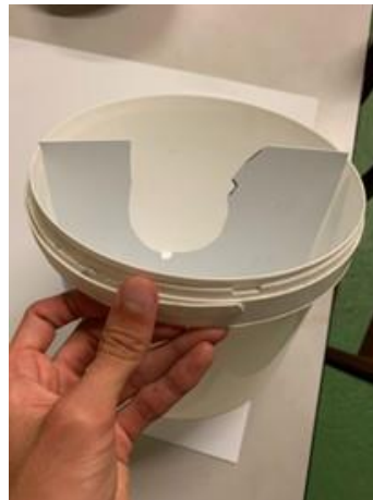
Figure 74 : Cloison en plastique pour aider au démoulage (Photographie personnelle, 2024)
