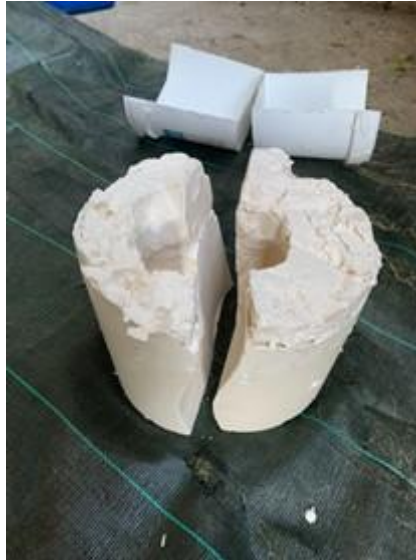
Figure 77 : Séparation du moule en deux parties pour faciliter le démoulage de la pièce anatomique (Photographie personnelle, 2024)
