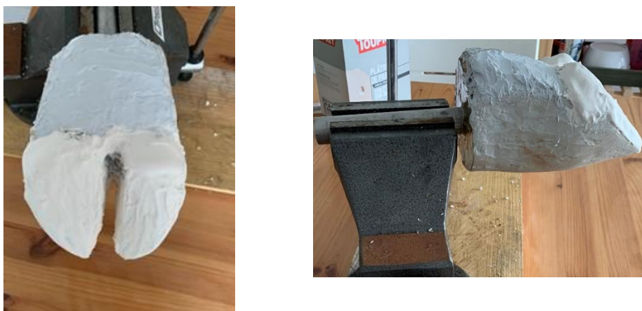
Figure 80 : Mannequin de pied après ajout de plâtre sur les onglons et avant l'étape de ponçage, (Photographie personnelle, 2024)
