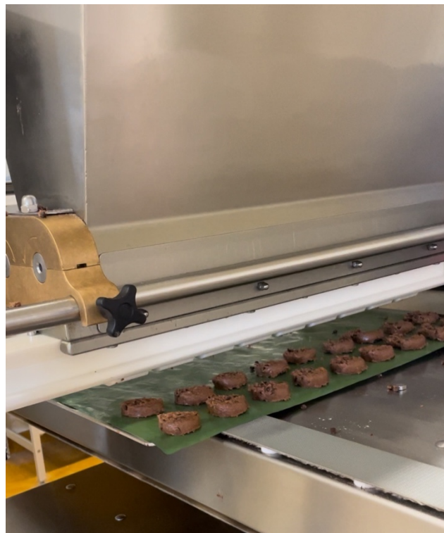
Figure 14 : Image du dépôt des biscuits sur la plaque de cuisson en silicone par la dresseuse
