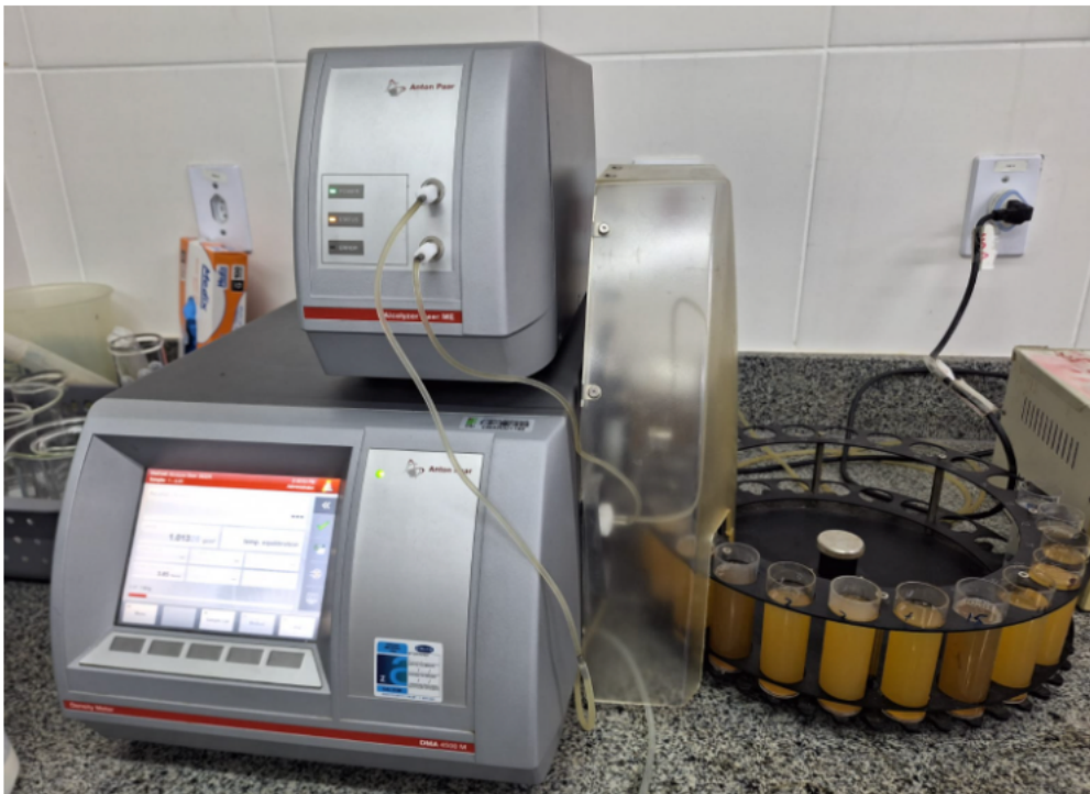
Figure 5 : Appareil Alcoalyzer utilisé pour le contrôle qualité (Kronenberg, 2024).
