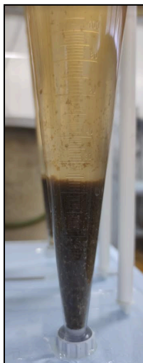
Figure 26 : Cône Imhoff après 20 minutes de sédimentation d'un bac en système biofloc avant l'ajout des post-larves
