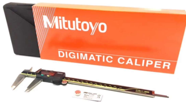
Figure 38 : Photographie du pied à coulisse digital Mitutoyo® utilisé pour les mesures des longueurs musculaires et des fibres musculaires.
