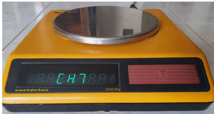
Figure 37 : Photographie de la balance Sartorius® utilisée pour la mesure de la masse musculaire.
