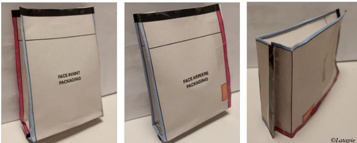
*Figure 19 : Photographies du prototype d'un sachet coussin montrant les zones de soudures, vu de face (à gauche), de derrière (au milieu) et du dessous (à droite) :*
