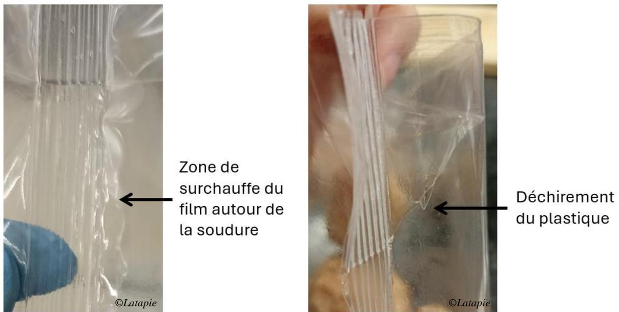
Figure 9 : Photographies qui montrent à gauche la surchauffe anormale du film autour de la soudure et à droite l'exemple d'un déchirement de sachet de la DLC exploratoire dû à la surchauffe autour de la soudure :
