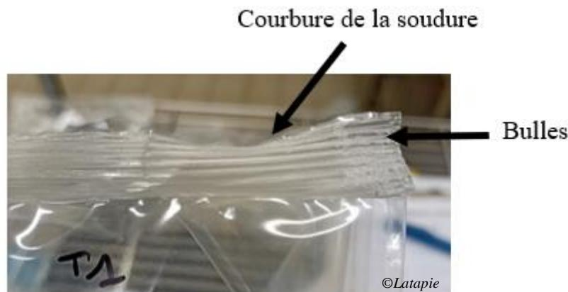
*Figure 7 : Photographie d'une soudure qui possède une courbure et des bulles dû à une surchauffe lors de la soudure :*
