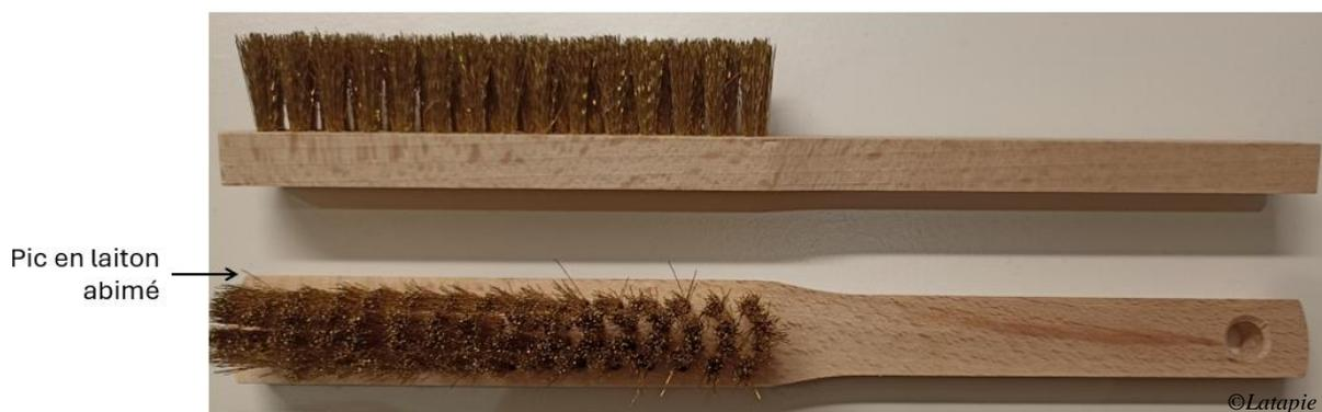
*Figure 17: Photographie légendée de deux brosses en laiton (une vue du dessus, l'autre vue de côté) identifiant un des pics susceptibles de se retirer ou de se casser :*
