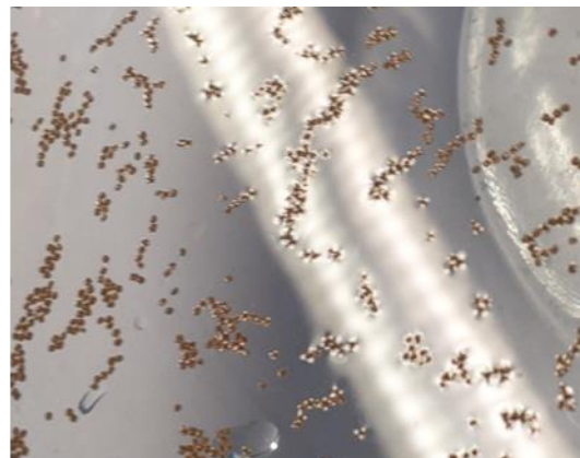
Figure 50 : Absence de film lipidique à la surface de l'eau après immersion d'un même échantillon, immédiatement après sa préparation (à gauche) ou 12h plus tard (à droite)
