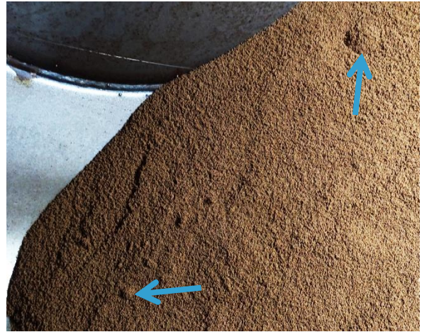
Figure 42 : Grumeaux (flèches bleues) visibles au fond de la mélangeuse après 5 minutes de mélange
