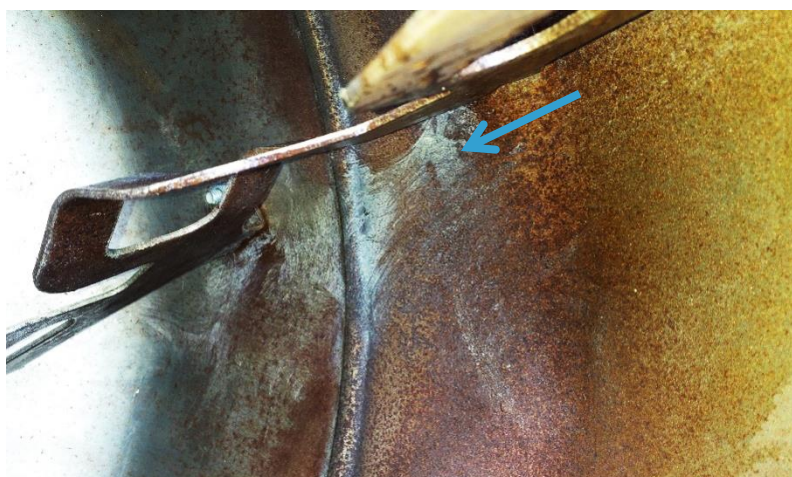
Figure 52 : tambour de la mélangeuse après deux nettoyages à l'aide d'une éponge et de détergent. Le dépôt d'OTC est montré par la flèche bleue
