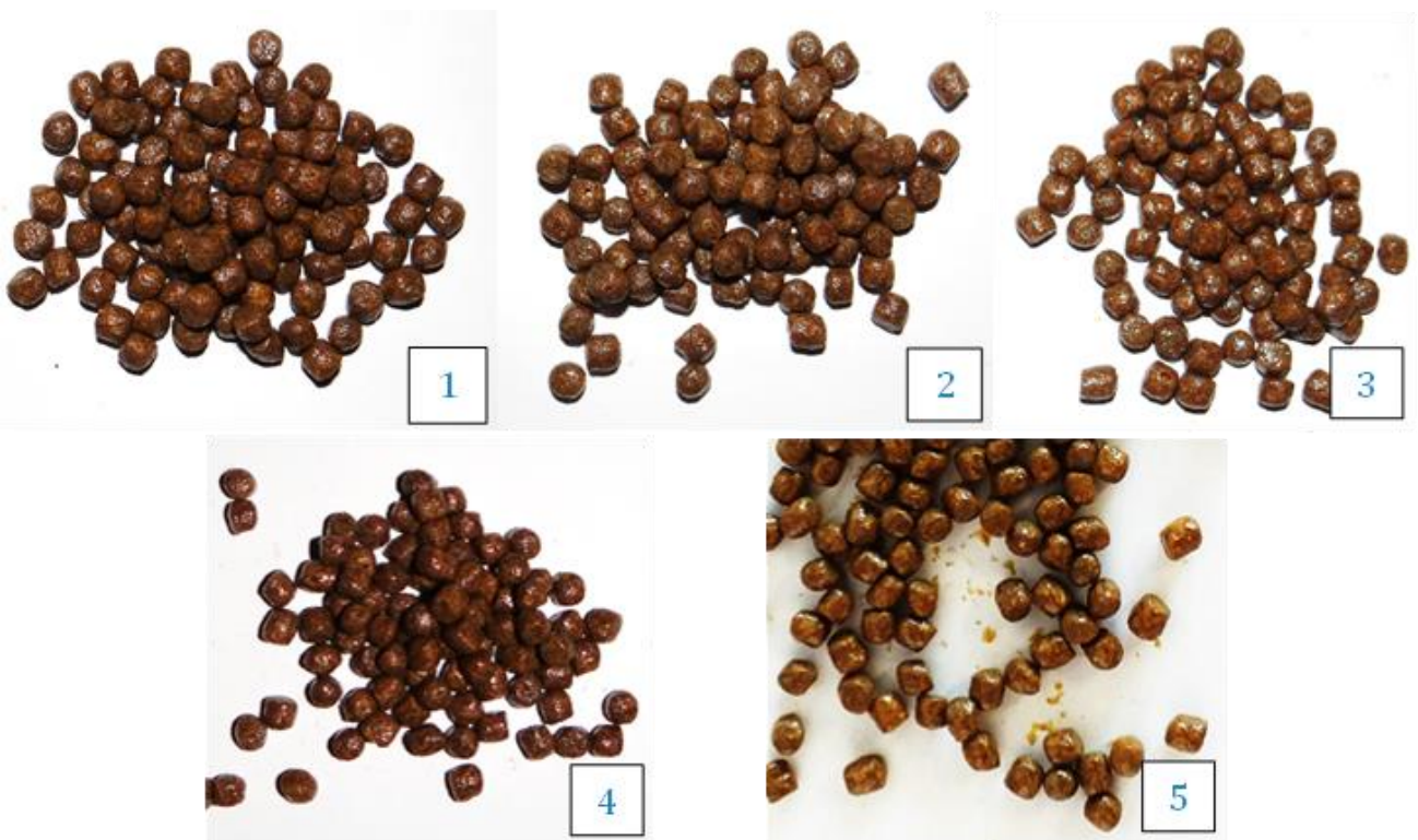
Figure 33 : Aspect des granulés après mélange, selon la quantité d'huile incorporée (1 : 5 ml/kg, 2 : 10 ml/kg, 3 : 15 ml/kg, 4 : 20 ml/kg et 5 : 30 ml/kg)
