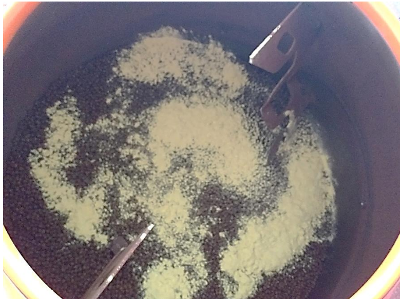
Figure 40 : Répartition de la poudre d'OTC à la surface de l'aliment, mélangeuse à l'arrêt
