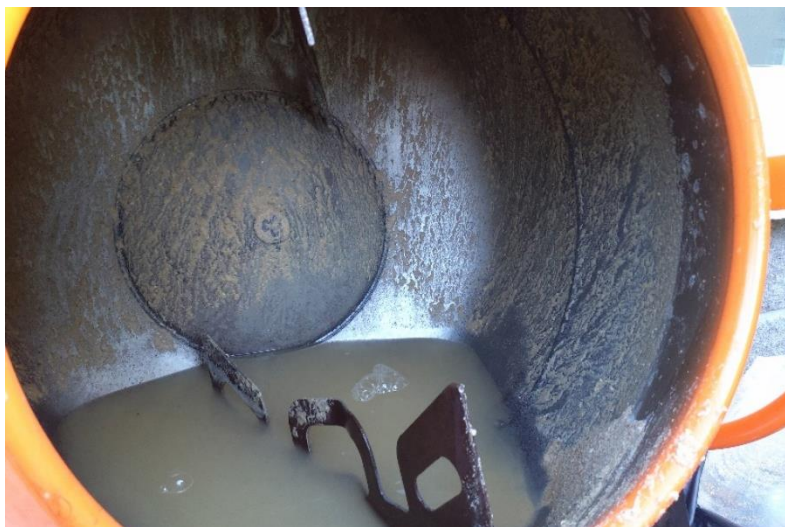
Figure 51 : Tambour de la mélangeuse après nettoyage à l'aide de graviers préalablement rincés
