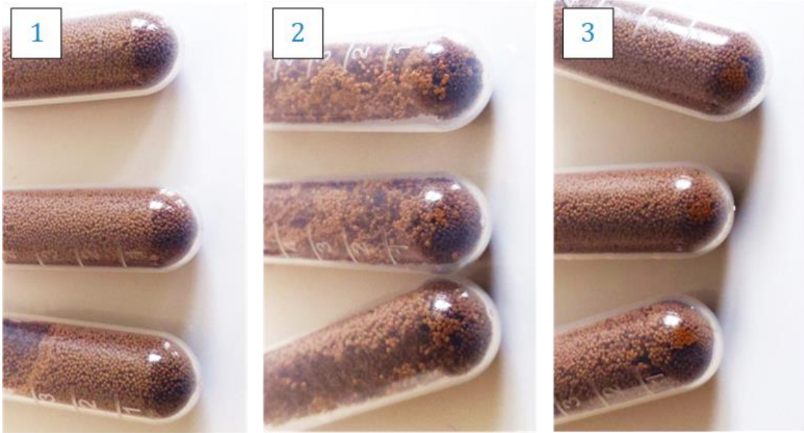
Figure 38 : Culots obtenus suite à la centrifugation des mélanges de la procédure C (FFN+EC) (1 : 30 ml/kg, 2 : 40 ml/kg, 3 : 50 ml/kg)
