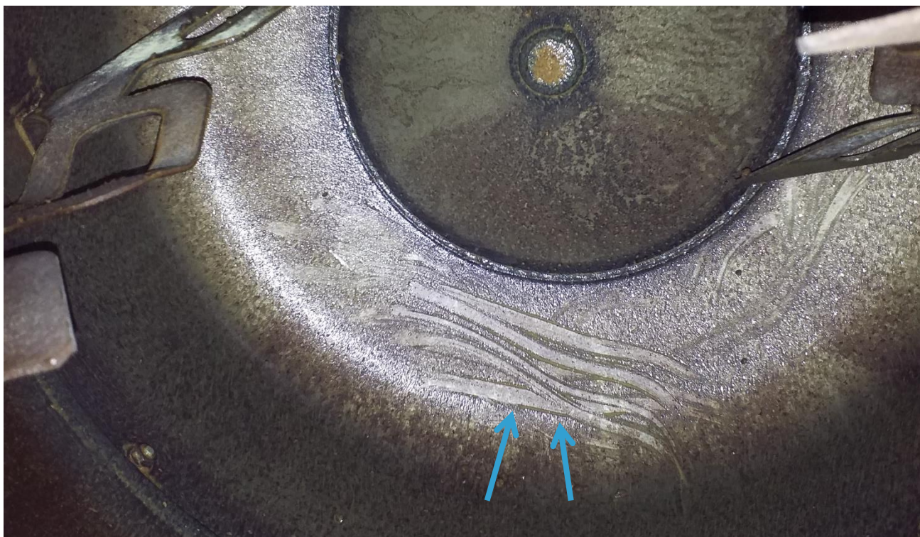
Figure 34 : Dépôt graisseux en fond de tambour (flèches bleues) après mélange avec 20 ml/kg d'huile
