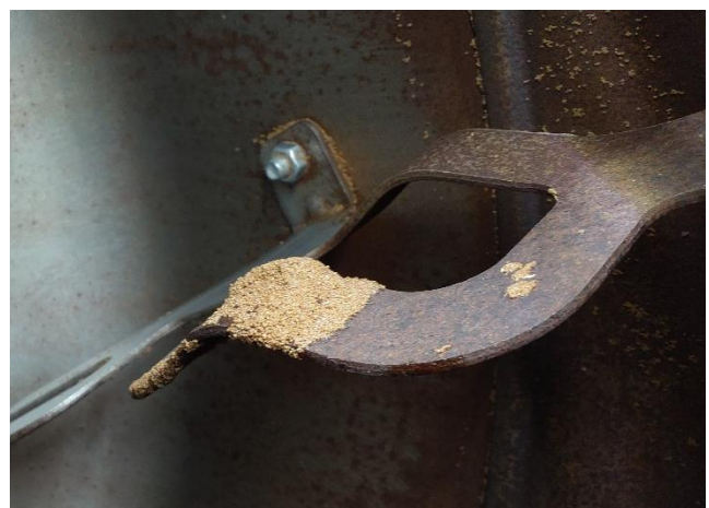
Figure 47 : Dépôt sur les pales de la mélangeuse après utilisation du pistolet drogueur
