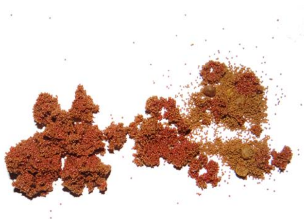
Figure 44 : Grumeaux récupérés à l'issue du mélange, après ouverture
