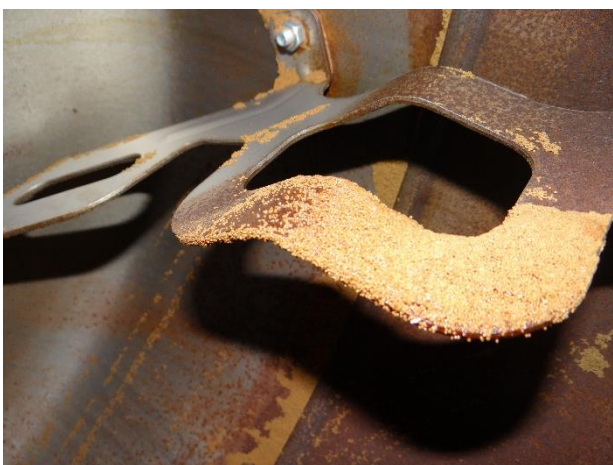
Figure 46 : Dépôt sur les pales de la mélangeuse après pulvérisation
