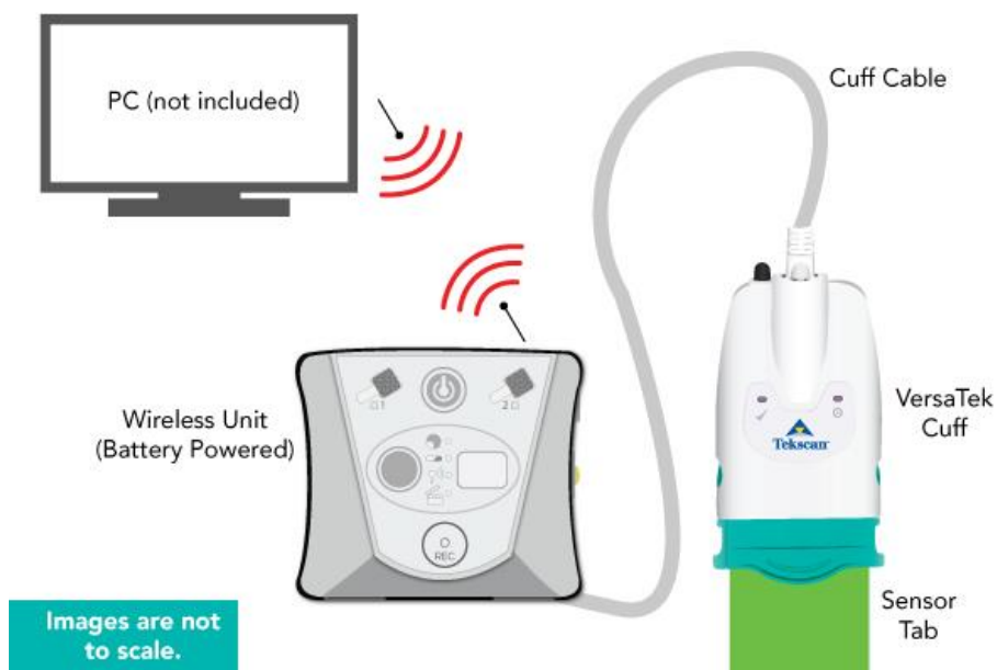
Figure 13 : Représentation schématique du système Hoof™ de Tekscan™ [52]
