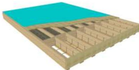
Figure 16 : complexe de plancher Trä8 d'épaisseur optimale. Source: Moelven
