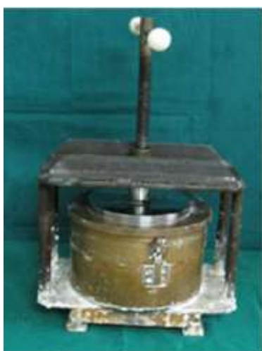
Figure 26 : Presseur permettant la construction de l'ultime moule de prothèse (Source : Sharavanan et al., 2015)
