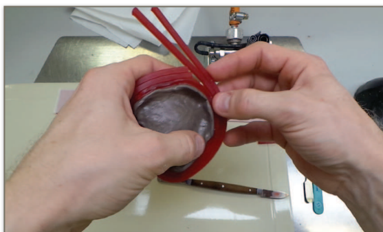
Entablement et coffrage réalisés à la cire
