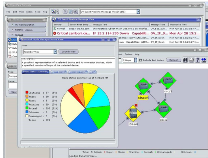
Figure 43 : Présentation du monitoring sous OpenView Network Node Manager (Hewlett-Packard, 2004)
