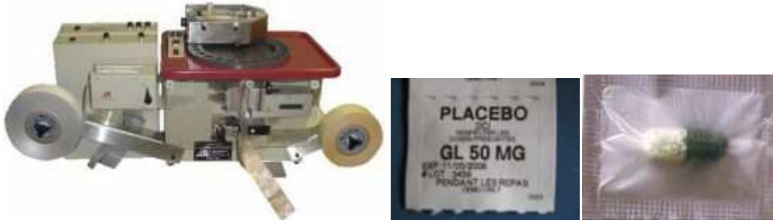
Figure 10 : MPI Autoprint et dose unitaire produite (12)
