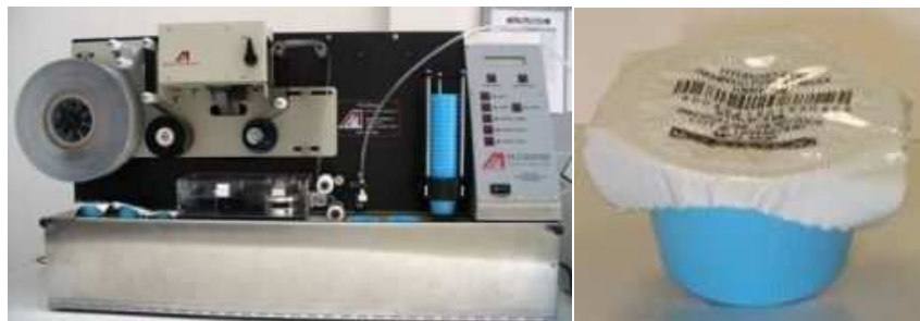
Figure 11 : MPI Fluidose et dose unitaire produite (12)
