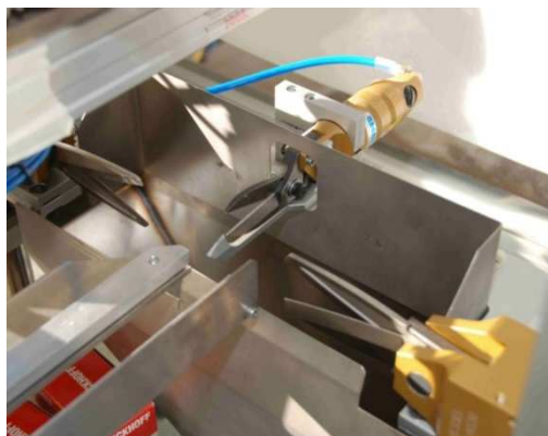
Figure 29 : ATTIS - Système de découpe à cisailles
