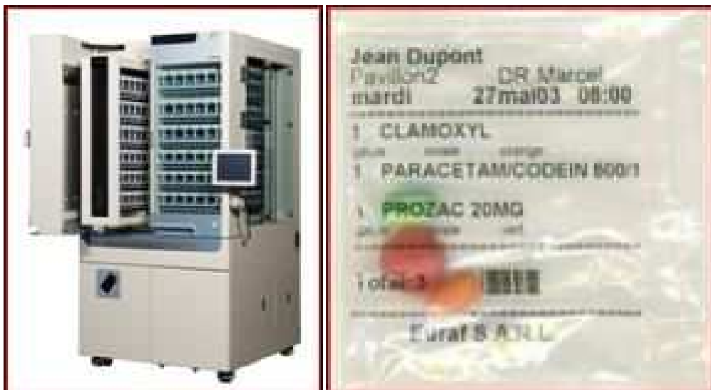
Figure 12 : L'automate SyGIPH et sachet nominatif produit (12)
