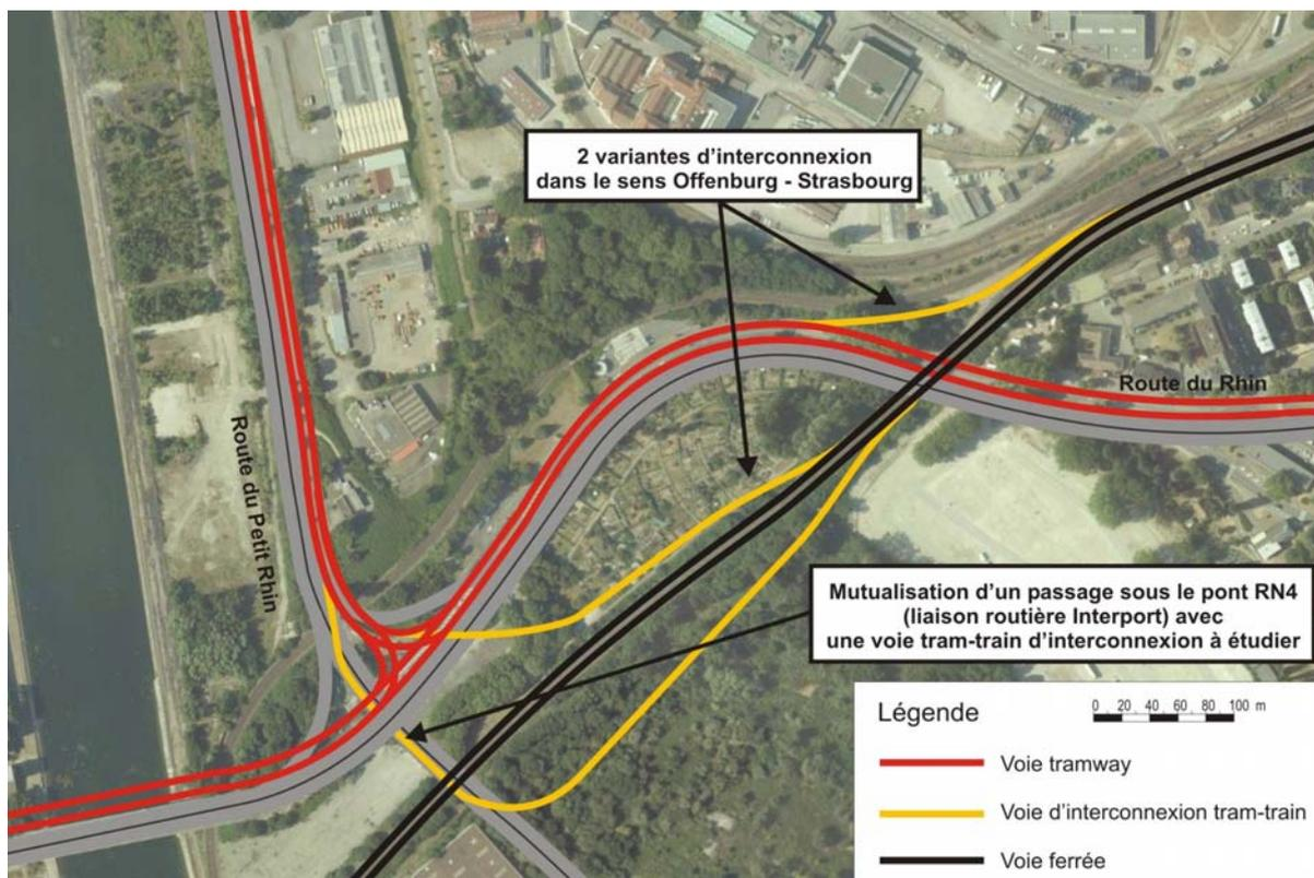
Figure 27 : Schéma d'interconnexion à STRASBOURG - Starlette
