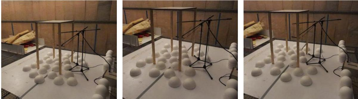
**Fig. 37 – Vue des différents arrangements à 31 % de demi-sphères de 25 cm de diamètre.**
