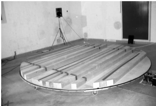
Ce coefficient permet de caractériser la dispersion pour l'utilisation dans les programmes d'acoustique géométrique, et notamment les méthodes basées sur le tir de rayons. Ces logiciels souffrent aujourd'hui d'une mauvaise estimation de la diffusion, ce qui impacte plus particulièrement les réflexions précoces des ondes sonores et entraîne des écarts de calcul sur les paramètres acoustiques qui en dépendent comme la clarté, ainsi qu'une surestimation de la durée de réverbération.
