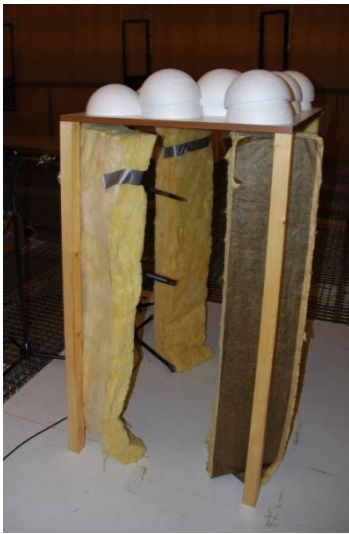
Fig. 34 – Vue du montage avec laine de verre autour des supports.
