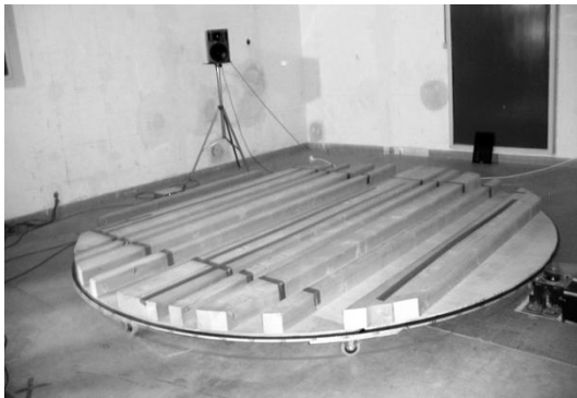
Fig. 3 – Montage sur plateau tournant en chambre réverbérante, CSTB (ISO 17497-1).
