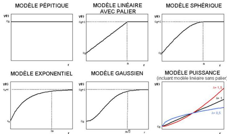
FIG. 2.2: Représentation des différents modèles de variogramme
