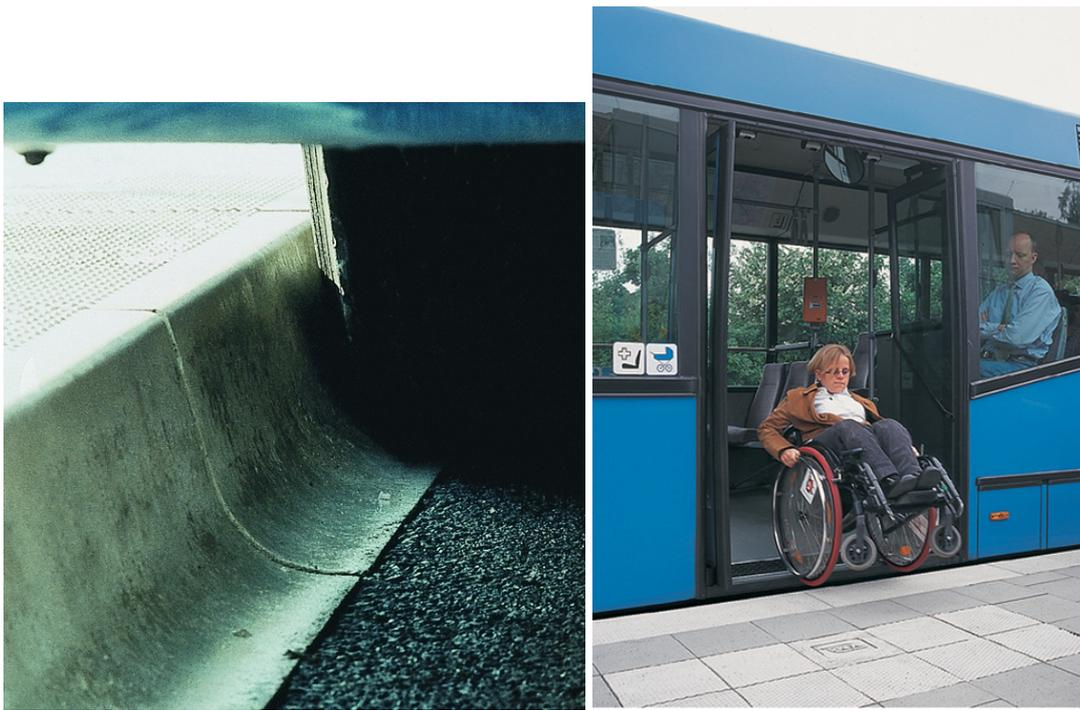
Figure 21 : BHNS avec guidage mécanique. Source : TTK
