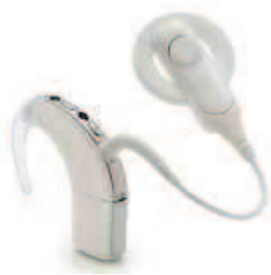
Figure 5: Partie externe d'un implant sans boîtier ; Marque Cochlear® ( http://www.cochlear.com/files/assets/nucleus-5/adult/lp_products_cn5_02.jpg )
