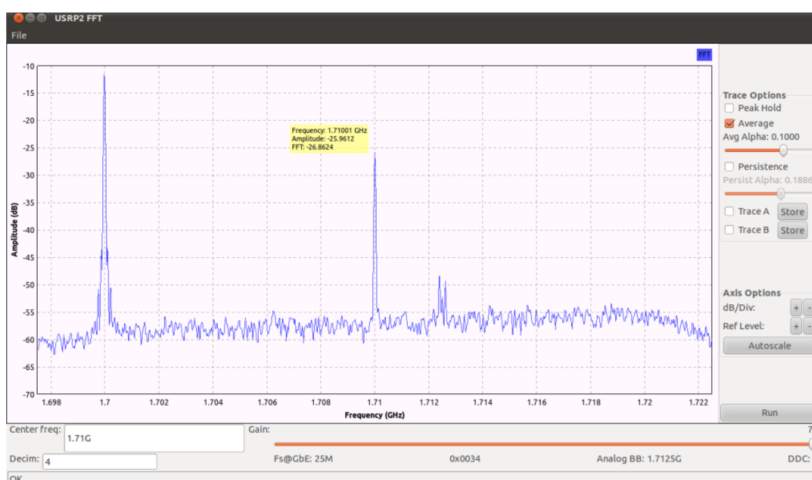
Figure 48 : Visualisation d'une raie parasite de niveau supérieur au signal mesuré
