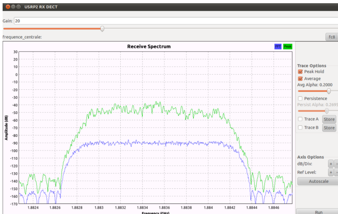
Figure 61 : Effet du filtre de canal FIR
