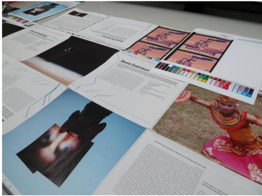
Des planches test sont imprimées afin d'observer le rendu des couleurs.
