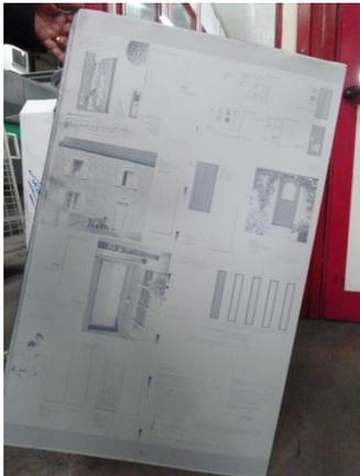
Dans un premier temps, le fichier de la brochure transmis à l'imprimerie est gravé sur des plaques en aluminium. L'impression étant en quadrichromie CMJN, quatre plaques sont réalisées : une où sont représentés les éléments cyan (C), une pour les éléments magenta (M), une pour le jaune (J) et une dernière pour le noir (N).
