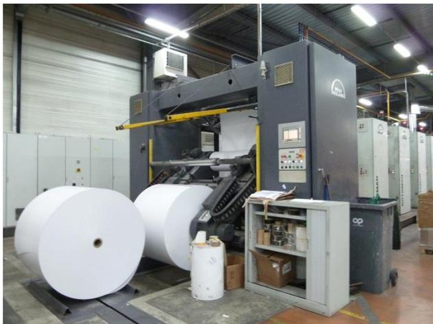
Ces plaques sont ensuite disposées dans leurs encriers correspondants sur la machine d'impression offset. De gros rouleaux de papiers vont traverser les différents bacs d'encre. L'encre se dépose alors uniquement aux endroits gravés sur la plaque pour chacune des couleurs.
