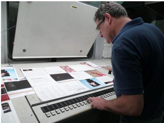
Si on trouve qu'il y a trop de bleu ou que le noir n'est pas suffisamment prononcé à certains endroits par exemple, l'imprimeur réalise des réglages très fins qui permettent de réajuster les couleurs par colonne.
