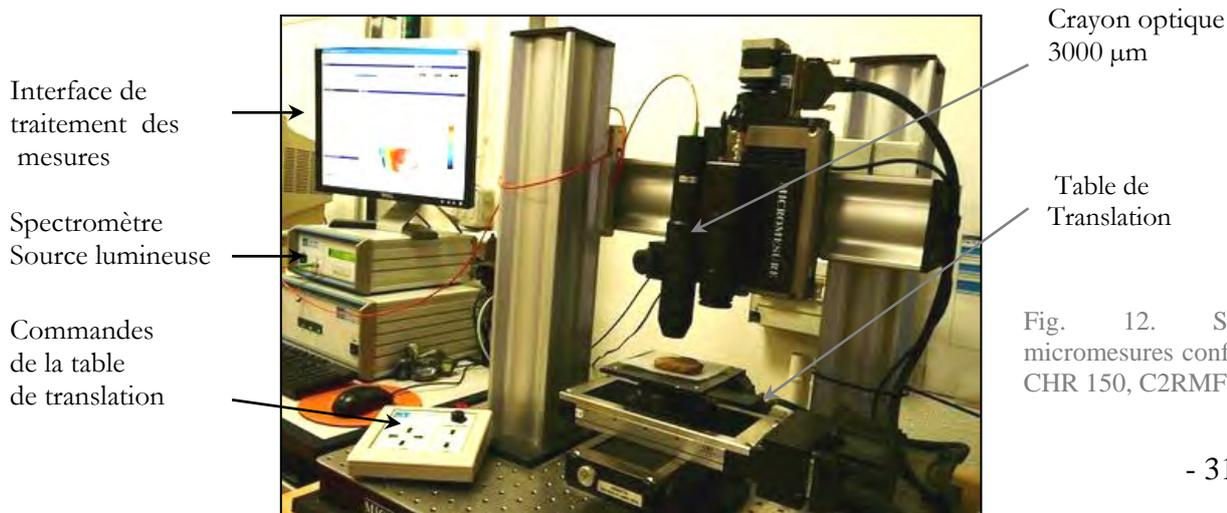
Fig. 12. Station de micromesures confocales STIL-CHR 150, C2RMF
