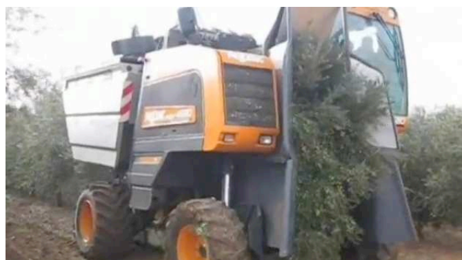
Figure 80. Enjambeur permettant la récolte d'olives par secouage des arbres
