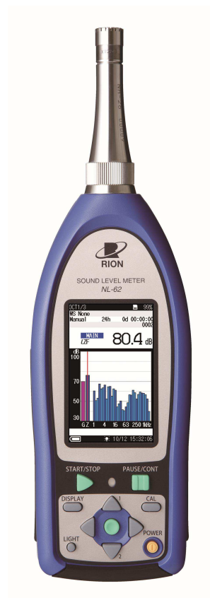
Exemple de sonomètre n°2, intégrateur classe I (g)
