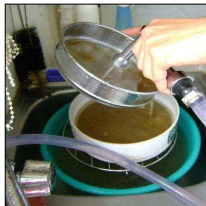
Figure 8: technique de filtration de substrat en vue d'isoler les spores d'AMF. Laure Priou, 2013
