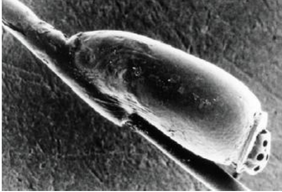
Figure 5 : Lente fixée à un cheveu vu au microscope électronique [6]
