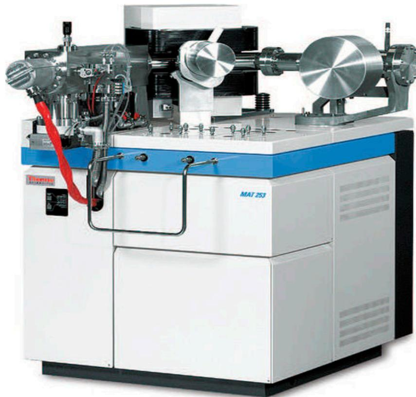
**Figure 28 : un Spectromètre de Masse de Rapport Isotopique ou IRMS.**
