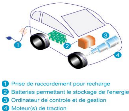
Figure 1 Fonctionnement d'un véhicule électrique
